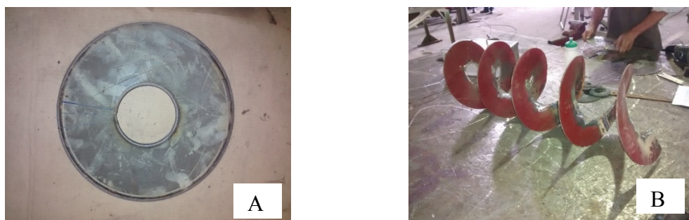
Figura 4 – (A) Disco de aço para construção do helicóide e (B) montagem do helicóide.
