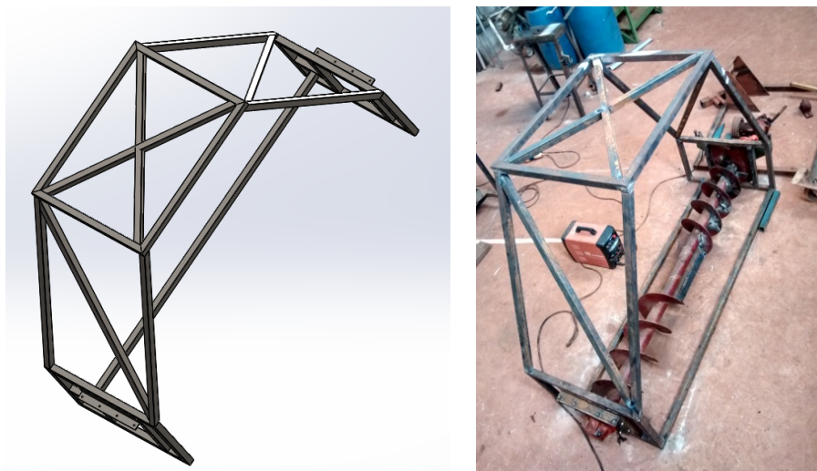
Figura 2 –Vista isométrica com ênfase nas estruturas de reforço.
