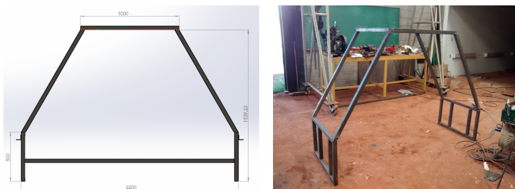
Figura 1 – Vista frontal da estrutura principal de revolvimento com medidas em mm.
