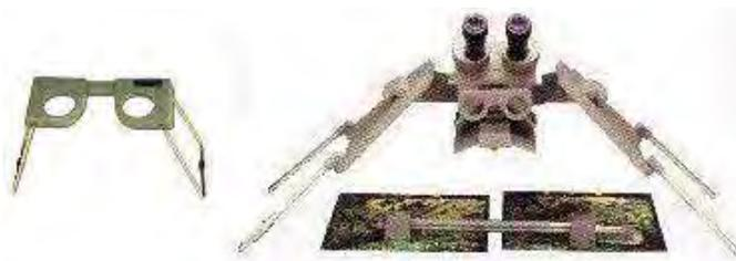
Figura 26 - Estereoscópio de bolso (à esquerda) e estereoscópio de espelhos com barra de paralaxe montada sobre as fotos (à direita) (COELHO E BRITO, 2002 pg. 259)
