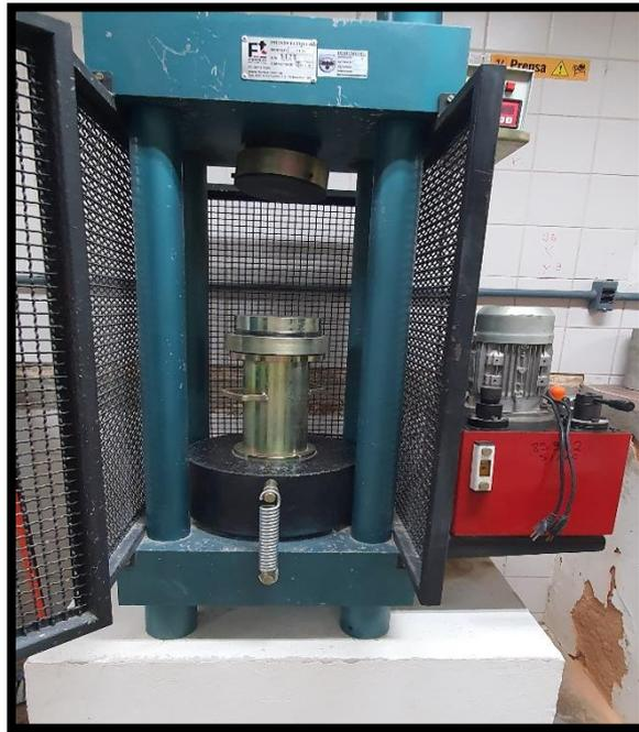
Figura 9 - Prensa Fortest® para teste de compressão, modelo FT 01. A prensa foi utilizada para realização de teste biomecânico de compressão dos corpos de prova contendo fratura transversa de ílio com correção de placa e parafuso (GC) e com fixação por meio de parafusos pediculares modificados (GP). Fonte: arquivo pessoal.
