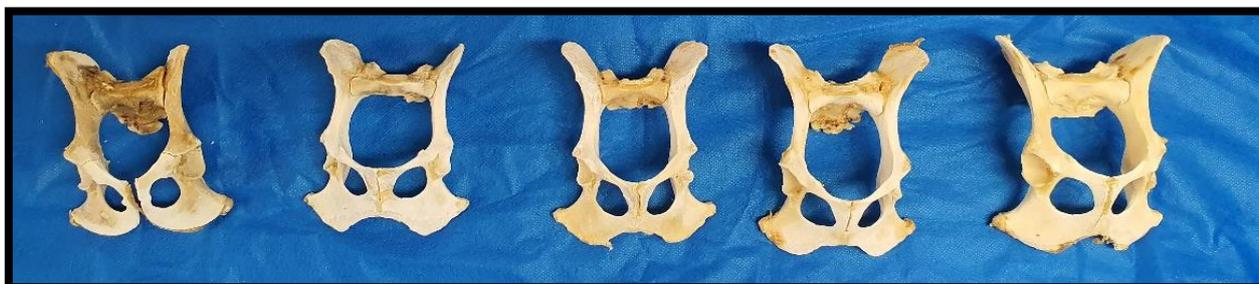
Figura 4 – Pelves caninas naturais após preparação e dissecação da musculatura adjacente, que foram utilizadas para geração dos corpos de prova, para posterior fratura transversa ilíaca e correção com placa e parafuso (GC) e com os parafusos pediculares monoaxiais modificados, para avaliação biomecânica por prensa. Fonte: arquivo pessoal do autor.
