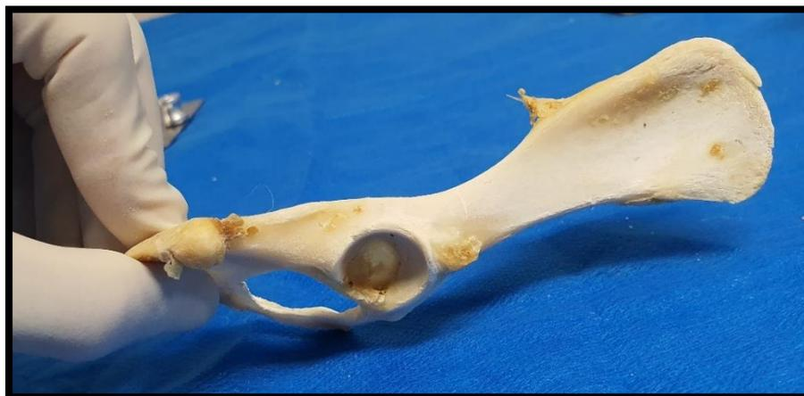
Figura 5 – Resultado final da confecção dos corpos de prova a partir de pelves caninas naturais após preparação e desarticulação sacro ilíaca para a formação de hemipelvas. Os corpos de prova foram utilizados para avaliação biomecânica da aplicação de parafusos monoaxiais modificados para correção de fraturas ilíacas transversas. Fonte: arquivo pessoal.
