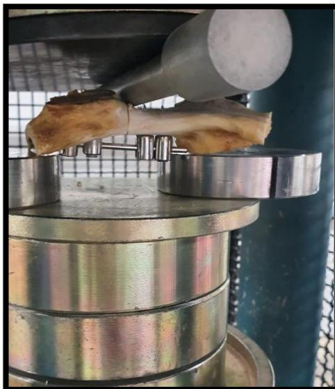
Figura 7. Posicionamento dos corpos de prova para ensaio biomecânico de compressão dos corpos de prova contendo fratura transversa de ílio com correção de placa e parafuso (GC) e com fixação por meio de parafusos pediculares modificados (GP). Fonte: arquivo pessoal
