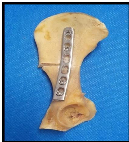
Figura 10. Fratura em corpos de testes de GC após aplicação das forças de compressão do ensaio biomecânico para avaliação da utilização de placa e parafuso para correção de fraturas transversas de ílio. Fonte: arquivo pessoal.
