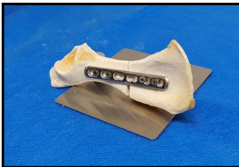
Figura 6 - Modelo de hemipelve do grupo controle (GC) após implantação de placas e parafusos para a correção de fraturas ilíacas transversas, antes da aplicação da força, para avaliação biomecânica e comparação com a utilização de parafusos monoaxiais modificados. Fonte: arquivo pessoal.
