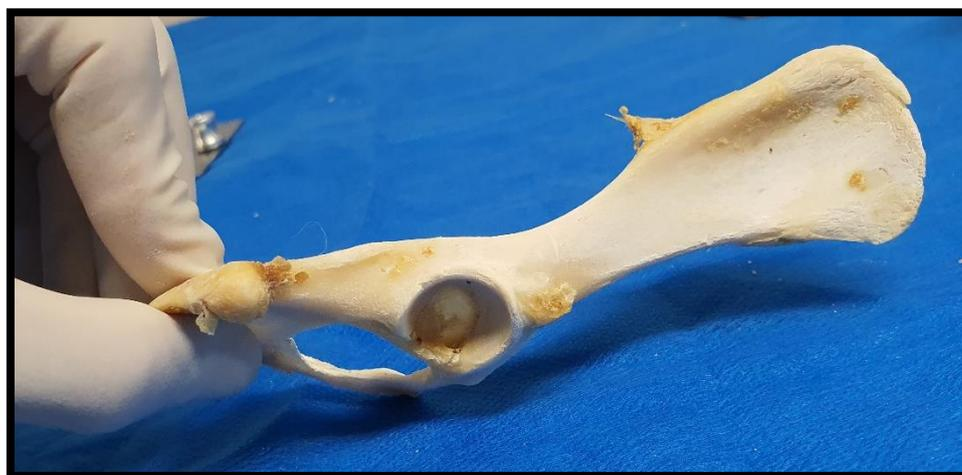
Figura 2. Resultado final da confecção dos corpos de prova a partir de pelves caninas naturais após preparação e desarticulação sacro íliaca para a formação de hemipelves. Os corpos de prova foram utilizados para avaliação biomecânica da aplicação de parafusos monoaxiais modificados para correção de fraturas íliacas transversas. Fonte: arquivo pessoal do autor.
