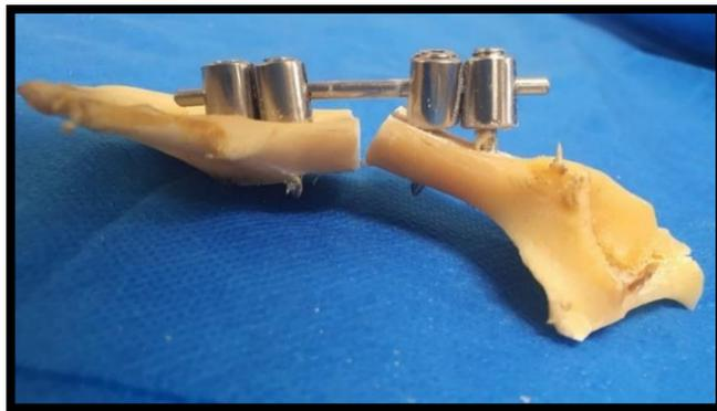
Figura 9. Avulsão de parafusos e distração do foco de fratura de GP após aplicação da força de compressão do ensaio biomecânico para avaliação da utilização de parafusos pediculares monoaxiais modificados para correção de fraturas transversas de ílio. Fonte: arquivo pessoal
