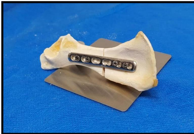
Figura 3. Modelo de hemipelve do grupo controle (GC) após implantação de placas e parafusos para a correção de fraturas íliacas transversas, antes da aplicação da força, para avaliação biomecânica e comparação com a utilização de parafusos monoaxiais modificados. Fonte: arquivo pessoal do autor.
