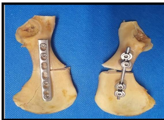
Figura 8. Fraturas em corpos de testes após aplicação das forças de compressão para comparação biomecânica da utilização de duas técnicas de reparação de fraturas transversas de ílio. Percebe-se que a utilização dos implantes buscou a similaridade das técnicas para melhor comparação entre ambas. **A:** Amostra C do GC, e **B:** Amostra C do GP. Fonte: arquivo pessoal
