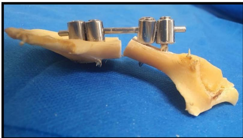
Figura 12 – Avulsão de parafusos e distração do foco de fratura de GP após aplicação da força de compressão do ensaio biomecânico para avaliação da utilização de parafusos pediculares monoaxiais modificados para correção de fraturas transversas de ílio. Fonte: arquivo pessoal
