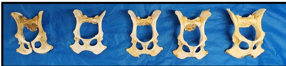
Figura 1. Pelves caninas naturais após preparação e dissecação da musculatura adjacente, que foram utilizadas para geração dos corpos de prova, para posterior fratura transversa íliaca e correção com placa e parafuso (GC) e com os parafusos pediculares monoaxiais modificados, para avaliação biomecânica por prensa. Fonte: arquivo pessoal do autor.
