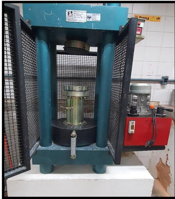
Figura 6. Prensa Fortest® para teste de compressão, modelo FT 01. A prensa foi utilizada para realização de teste biomecânico de compressão dos corpos de prova contendo fratura transversa de ílio com correção de placa e parafuso (GC) e com fixação por meio de parafusos pediculares modificados (GP). Fonte: arquivo pessoal.
