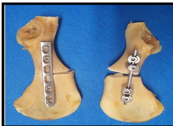
Figura 11 - Fraturas em corpos de testes após aplicação das forças de compressão para comparação biomecânica da utilização de duas técnicas de reparação de fraturas transversas de ílio. Percebe-se que a utilização dos implantes buscou a similaridade das técnicas para melhor comparação entre ambas. À direita amostra C do GC, e À esquerda amostra C do GP. Fonte: arquivo pessoal
