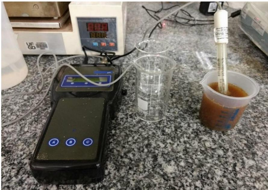
**Figura 7:** Fotografia do pHmetro digital utilizado para aferição do pH das amostras (Fonte: Acervo da autora).
