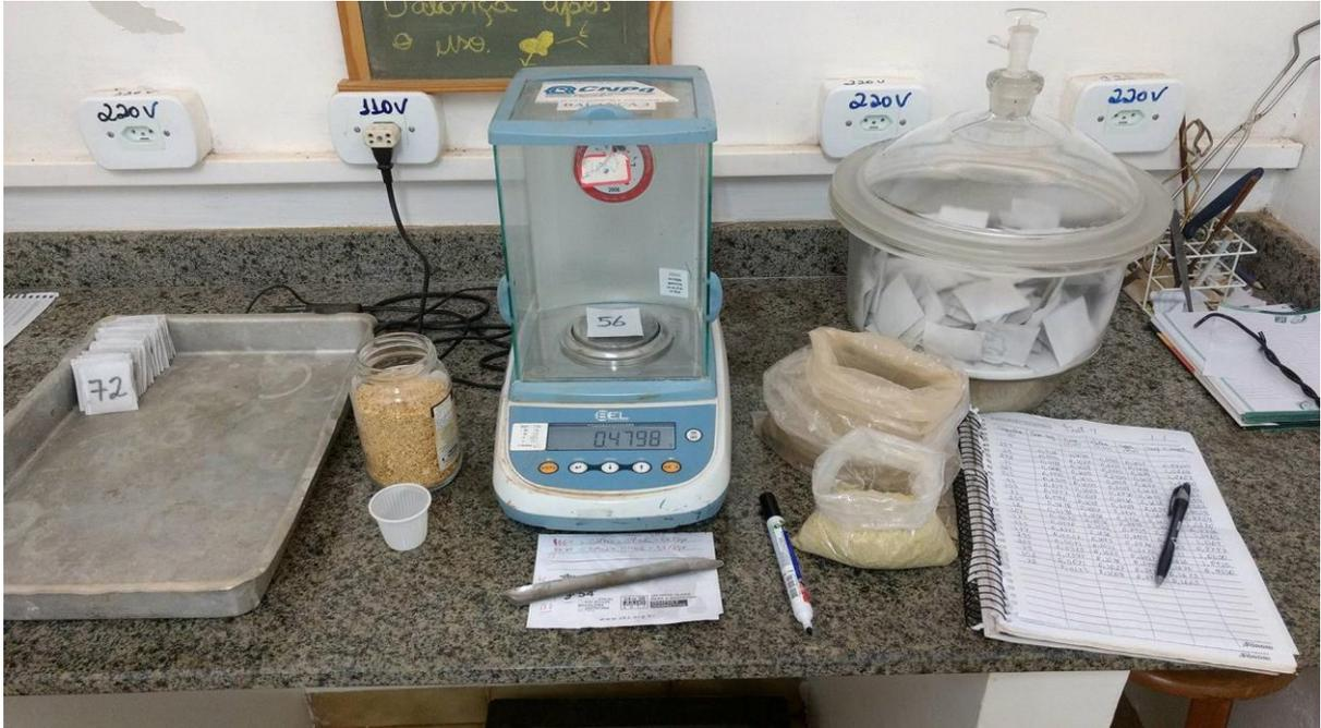
**Figura 2:** Balança analítica utilizada para pesar as amostras de alimentos utilizados no experimento (Fonte: Acervo da autora, 2018).
